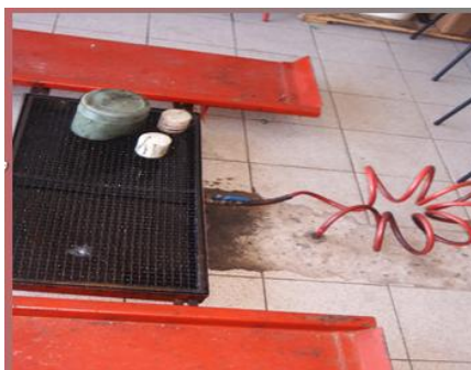
FIGURA 3 – Caixa separadora presente no elevador hidráulico Fonte: Elaboração própria (2009).
