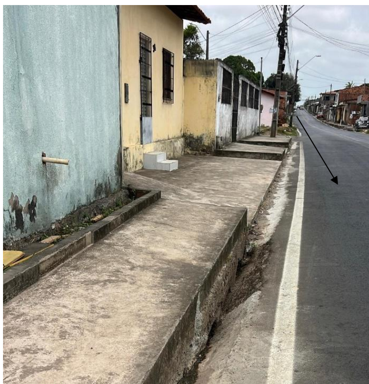
Figura 5: Vertente retilínea, representada na seta, e sistema de drenagem artificial ao longo da localidade Avenida Brasil, revestida por asfalto, evidenciando a impermeabilização do solo e a alteração na dinâmica natural de escoamento superficial.
