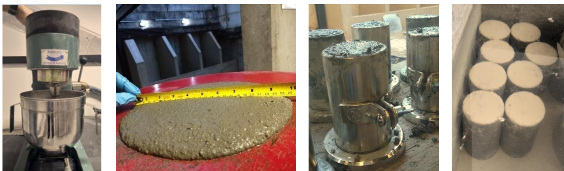
Figura 4: Produção das argamassas e corpos de prova. (a) misturador; (b) consistência; (c) moldagem de corpos de prova; (d) cura. FONTE: Próprio das autoras.
