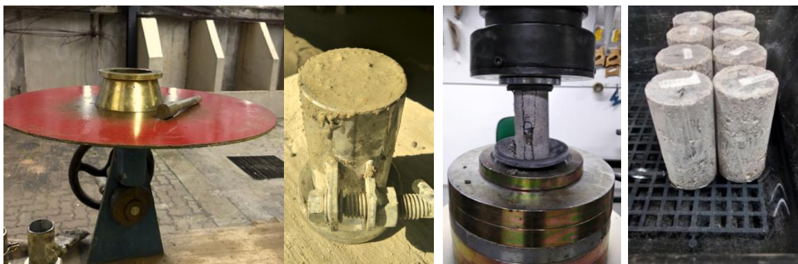
Figura 5: Ensaio realizados. (a) Índice de consistência; (b) Densidade de massa no estado fresco; (c) Resistência à compressão; (d) Absorção de água por capilaridade. Fonte: Próprio das autoras.
