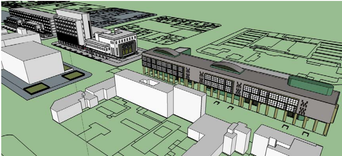
Fig. 4: Vista aérea del sector desde el extremo opuesto a la vista anterior. Los cuatro edificios poseen una galería o recova al Norte. Entre las prescripciones el plan establecía la construcción de recovas o galerías en la fachada norte de los edificios.
