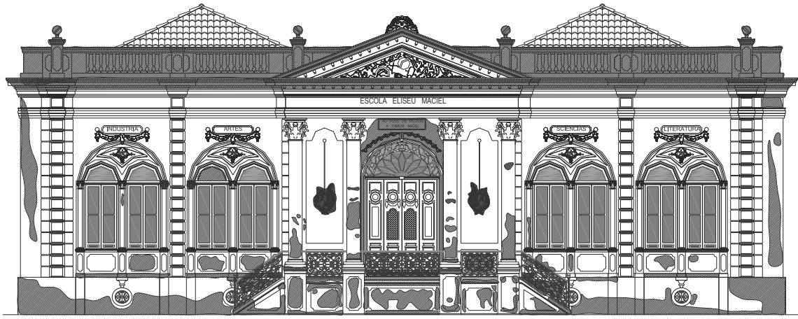
Figura 1: Fachada principal sudoeste com anomalias em 2006. Fonte: da autora.
