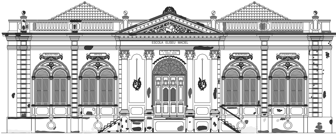
Figura 2: Fachada principal sudoeste com anomalias em 2010. Fonte: da autora.
