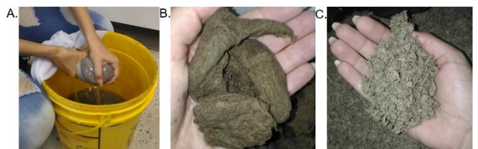
Figura 1: Processo de preparação da polpa de sacos de cimento: A torção da fibra, B, fibra após torção e C, fibra após dispersão
