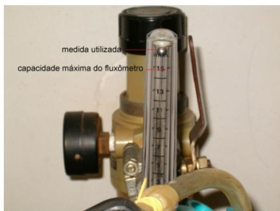
FIG. 12 – medição saturada do fluxômetro para as amostras de bocal livre.
