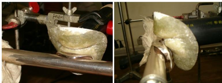
FIG. 7 – modelo de embocadura em fibra de vidro: a) visão frontal, b) visão lateral
