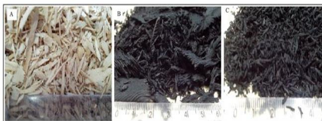
**Figura 1.** Materiais utilizados na confecção dos painéis MDP: A) Partículas de madeira de *Pinus* spp.; B) Raspas de pneu coletadas; C) Raspas de pneu retidas na peneira de 2,36 mm.
