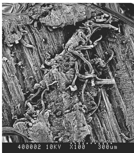
Figura 2. Imagem obtida por microscópio eletrônico de varredura, da matriz de lignina fundida e de células de madeira nela imersas. Fonte: Pizzi et al. (2004).
