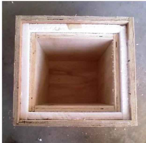
**Figura 2.** Construção de caixa de compensado com isolamento de Isopor®.
