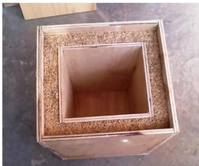
**Figura 3.** Construção de caixa de compensado com isolamento de casca de arroz.
