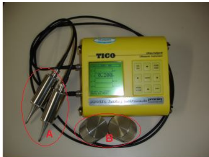
Figura 2. Aparelho de ultrassom e dois pares de transdutores; Transdutores de ponto seco (A); Transdutores de face plana (B).
