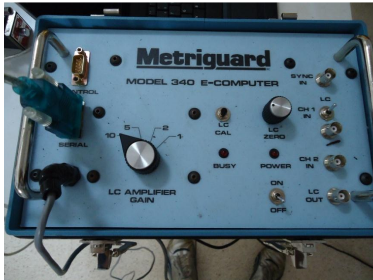
Figura 1. Aparelho para determinação do módulo de elasticidade transversal das vigotas.
