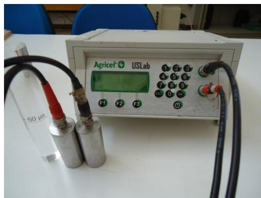
Figura 2. Aparelho de ultrassom para avaliação não destrutiva das vigas. Figure 2. Ultrasonic device used to evaluate nondestructively the beams.
