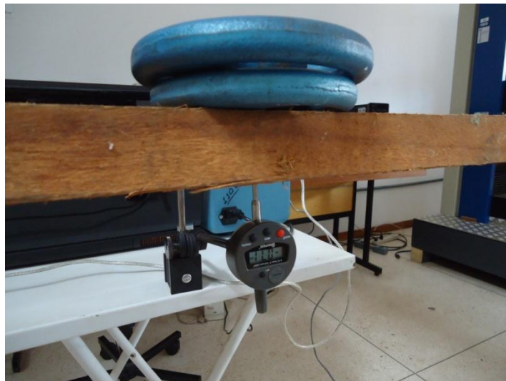
Figura 3. Determinação do módulo de elasticidade em flexão estática das vigas. Figure 3. Determination of the static bending modulus of elasticity of the beams.
