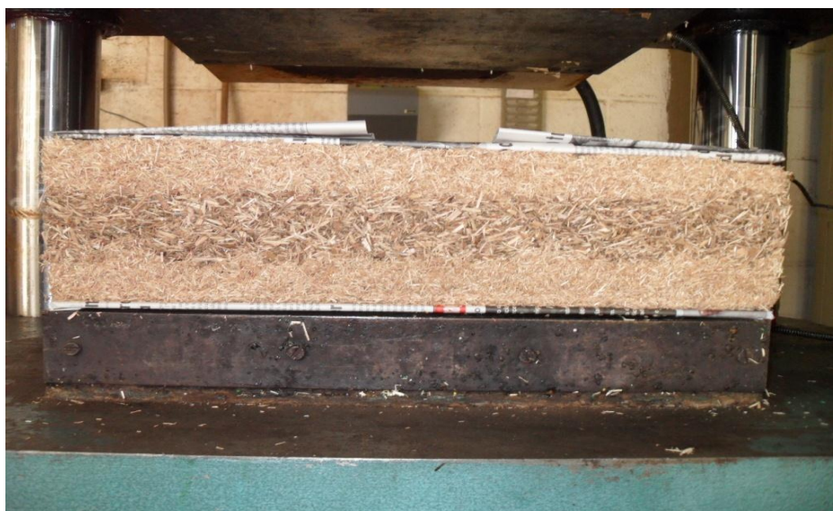
Figura 1. Colchão com as partículas antes da prensagem.
