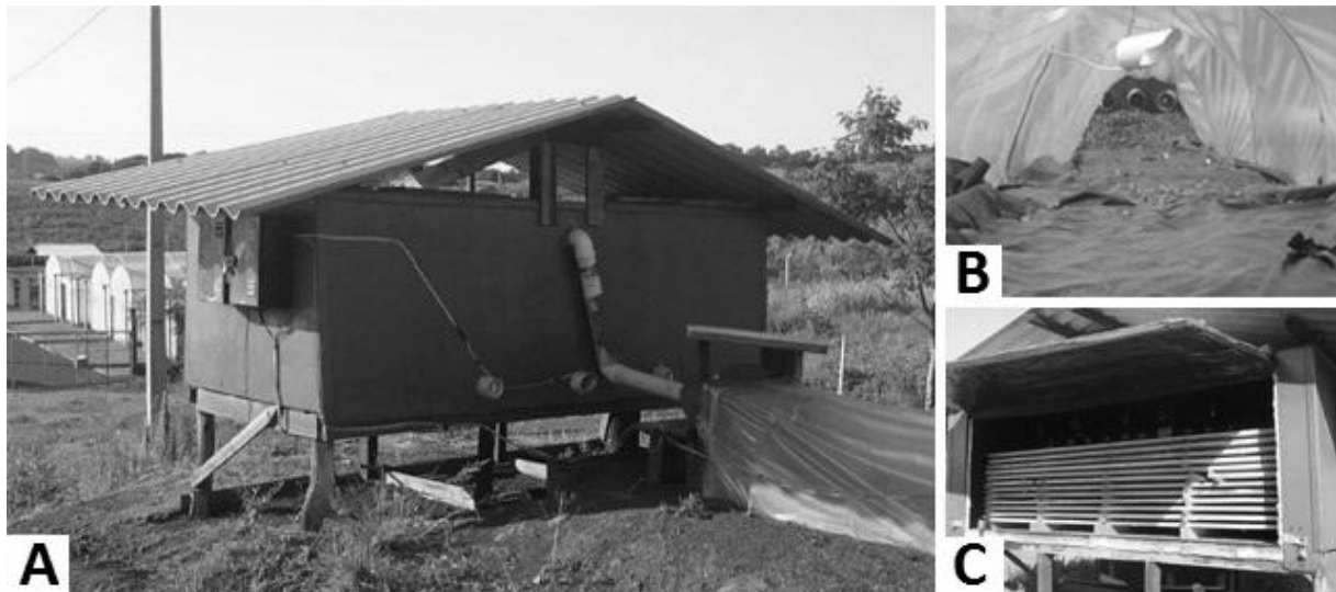
Figura 1. Secador solar utilizado no estudo (A); vista interna do coletor (B); vista interna do secador (C).
