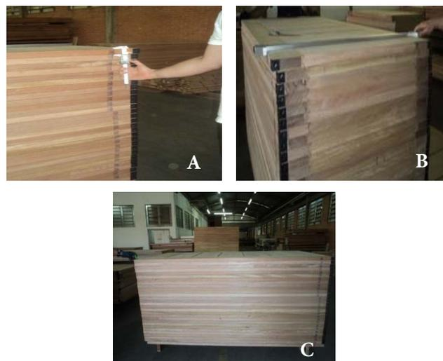
**Figura 3.** Medições realizadas nas portas: A) Espessura da porta com um paquímetro digital; B) Largura da porta com um paquímetro digital; C) Altura da porta com uma trena.
