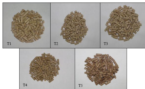
Figura 1. Pellets produzidos a partir da Ponteira de Eucalyptus , sendo T1, T2, T3, T4 e T5 os pellets obtidos de partículas com 8, 10, 12, 14 e 16% de umidade, respectivamente.
