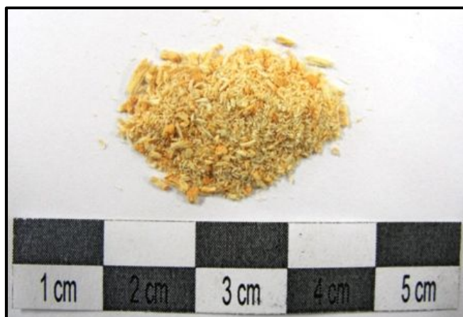
Figura 04 Fragmentos de carvão após a passagem pelo forno
