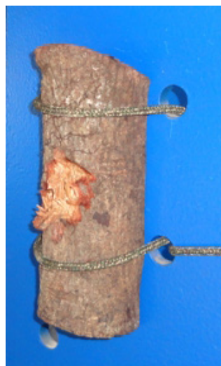
Fig. 10 - Toco de Angico ( Anadenanthera colubrina ), golpeado por lâmina de pedra, preso a viga de aço
