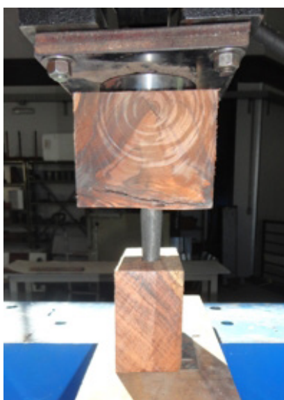
Fig. 9 - Réplica 4 submetida a testes de compressão em uma MTS, encabada em Jatobá ( Hymenaea coubaril ), com um gume pressionado contra um bloco de Jacarandá ( Dalbergia nigra )
