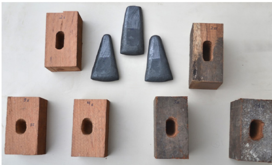
Fig. 7 - Réplicas de lâminas e blocos de diferentes madeiras para encabamento das mesmas
