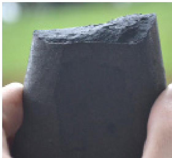
Fig. 15 - Réplica 4 re-fragmentada com Quebra Oblíqua
