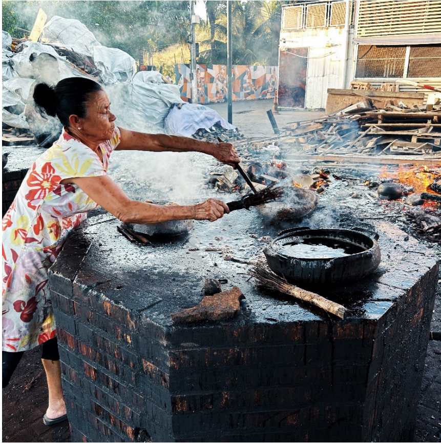
Tratamento de superfície pós-queima executado através do açoite com a muxinga pela Paneleira Evanilda Fernandes Correa
