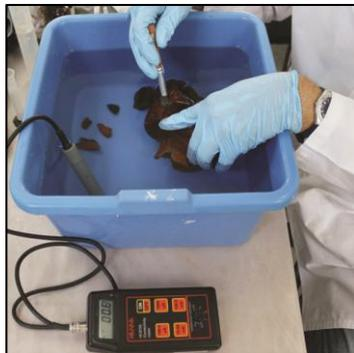
**Figura 21:** Limpeza aquosa (por imersão) com controle da condutividade da água. Foto: Agesilau Almada, 2012.
