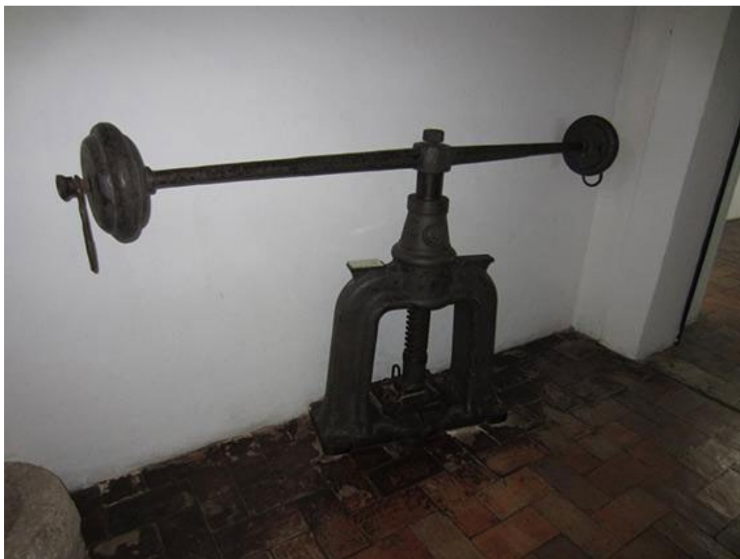
Figura 1. Prensa usada para a fabricação de ladrilhos hidráulicos. Acervo do extinto Museu Regional do IPHAN, Cachoeira. Foto: Carlos Costa, 2017.
