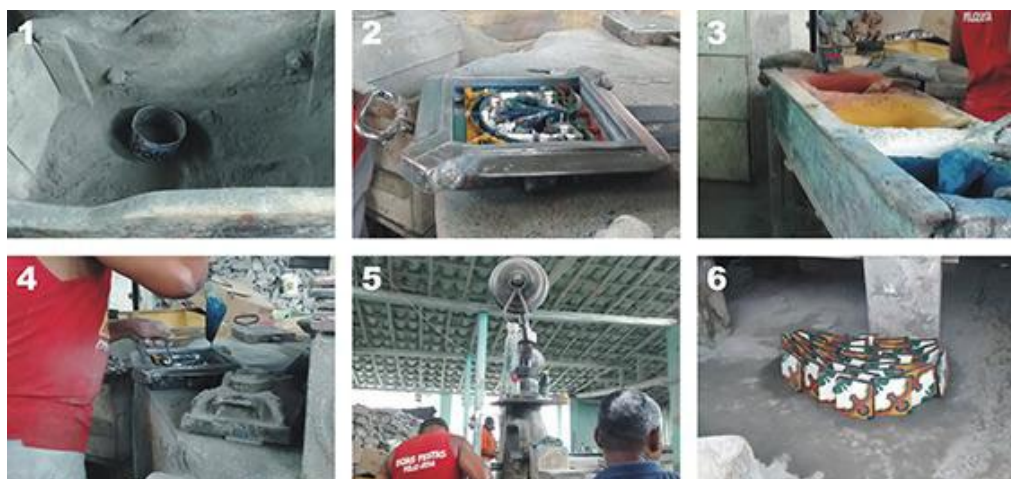
Figura 3. Cadeia operatória da produção de ladrilhos hidráulicos na Oficina do Manoel do ladrilho, Cachoeira, Bahia. Sequência de alguns procedimentos: 1) Tanque de cimento, 2) Preparo das tintas em cubas, 3) Forma metálica, 4) Preenchimento da forma com a tinta, 5) Prensagem e 6) Secagem. Fotos: Aline Marçal Santos. Arte final: Carlos Costa.
