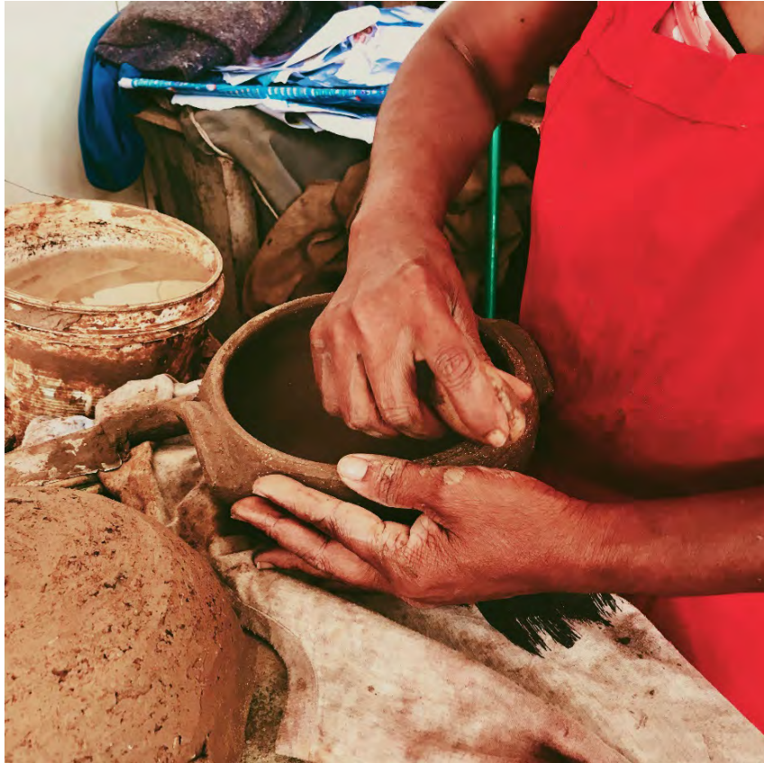
Execução da etapa de polimento a fim de uniformizar a superfície
