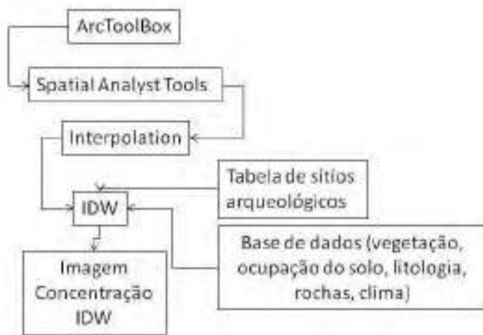
Figura 4 - Processamento realizado no ArcGis 10.2 para a elaboração de um mapa segundo a Ponderação do Inverso das Distâncias (IDW).
