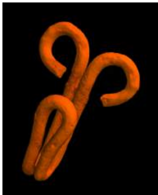
Figura 5 - Imagem em 3D gerada pelo programa CTvox do colchete, mostrando a sua morfologia sem a camada de produto de corrosão
