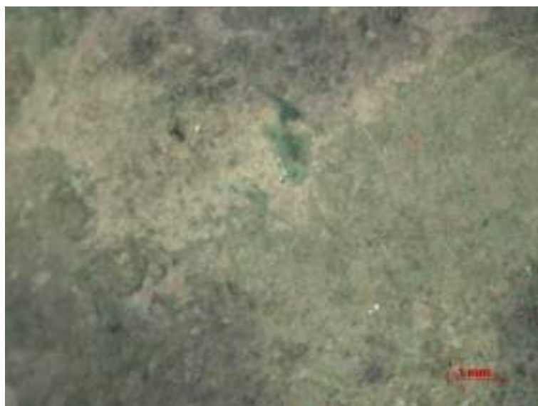
Figura 18 - Imagem obtida através do microscópio estereoscópico do botão, mostrando produtos de corrosão de diferentes colorações como verde claro e escuro e regiões avermelhadas
