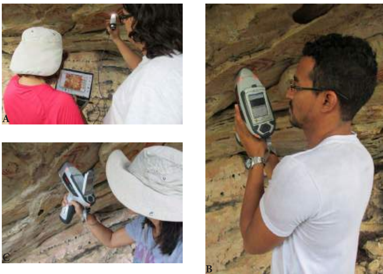
Figura 3: exame com microscopia portátil (A); análise por Fluorescência X portátil (B); medida com código Munsell de cores (C).
