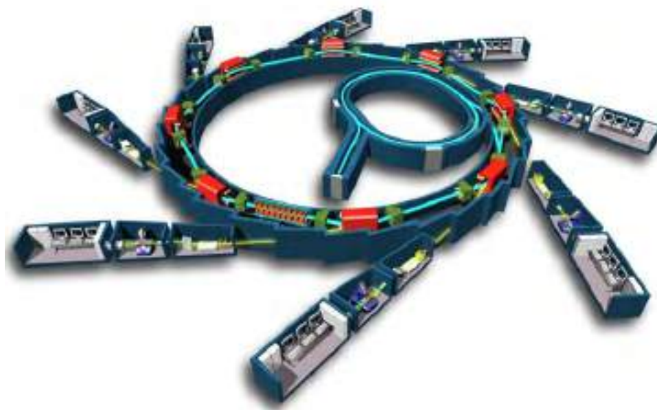
Figura 1: Esquema de uma fonte síncrotron, com o anel de armazenamento de elétrons e as linhas de luz posicionadas tangencialmente a ele, onde são realizados os experimentos. Fonte: https://fr.wikipedia.org/wiki/SOLEIL .
