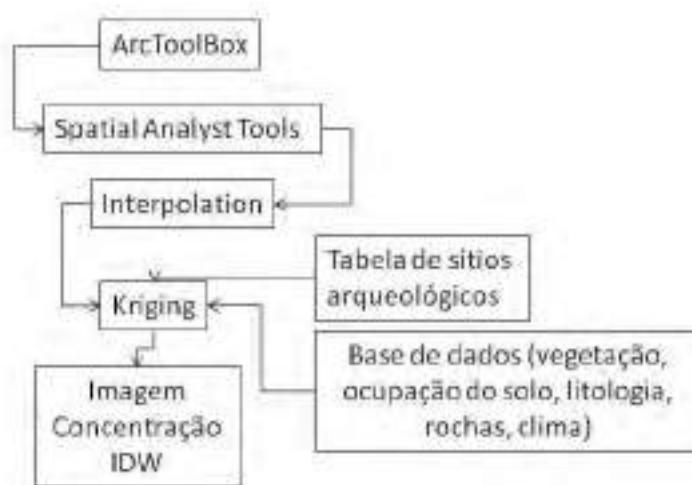
Figura 5 - Processamento realizado no ArcGis 10.2 para a elaboração de um mapa segundo o método da Krigagem. Fonte: Perez (2018).
