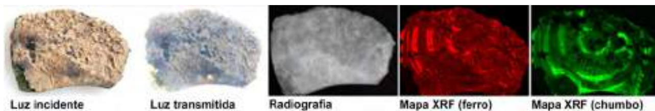
Figura 4: Comparação entre imagens óticas e mapeamentos por fluorescência de raios X dos elementos ferro (Fe) e chumbo (Pb), mostrando uma pintura invisível a olho nu em um vidro medieval da coleção da Historic England. Adaptado de http://www.blue-scientific.com/analysing-medieval-window-glass-micro-xrf/ .
