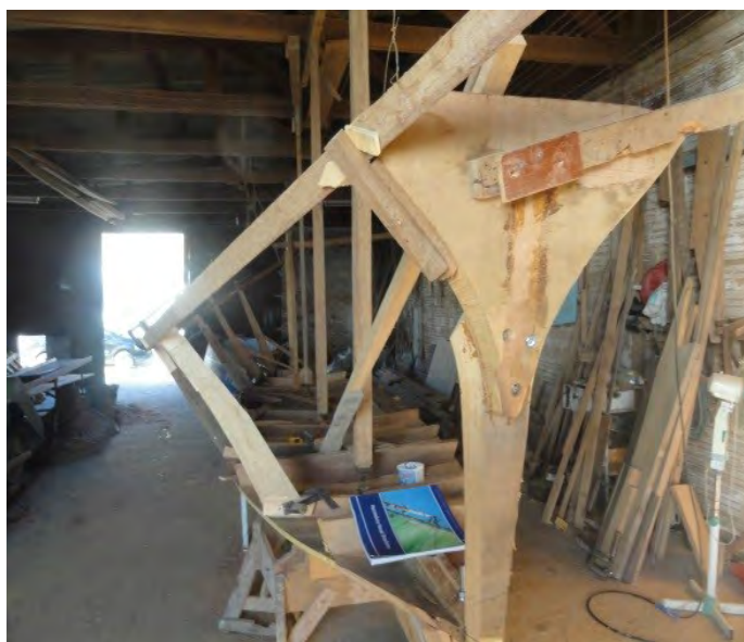
Figura 6: Estrutura de uma canoa em construção. Fonte: Adomilli, (dados, pesquisa 2017).
