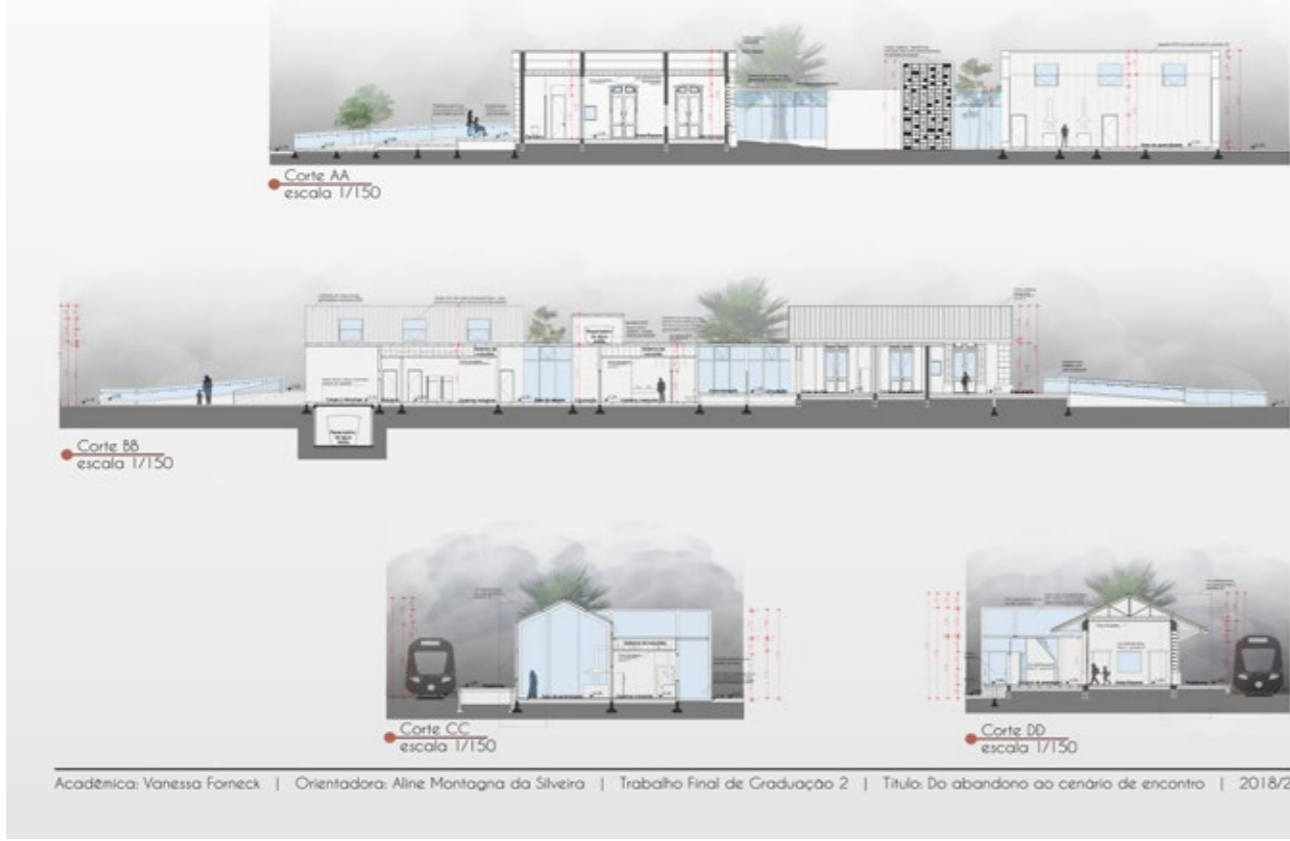
Figura 10 - Cortes da proposta projetual para a Estação Theódosio e para a nova edificação. Fonte: Autora, 2018.
