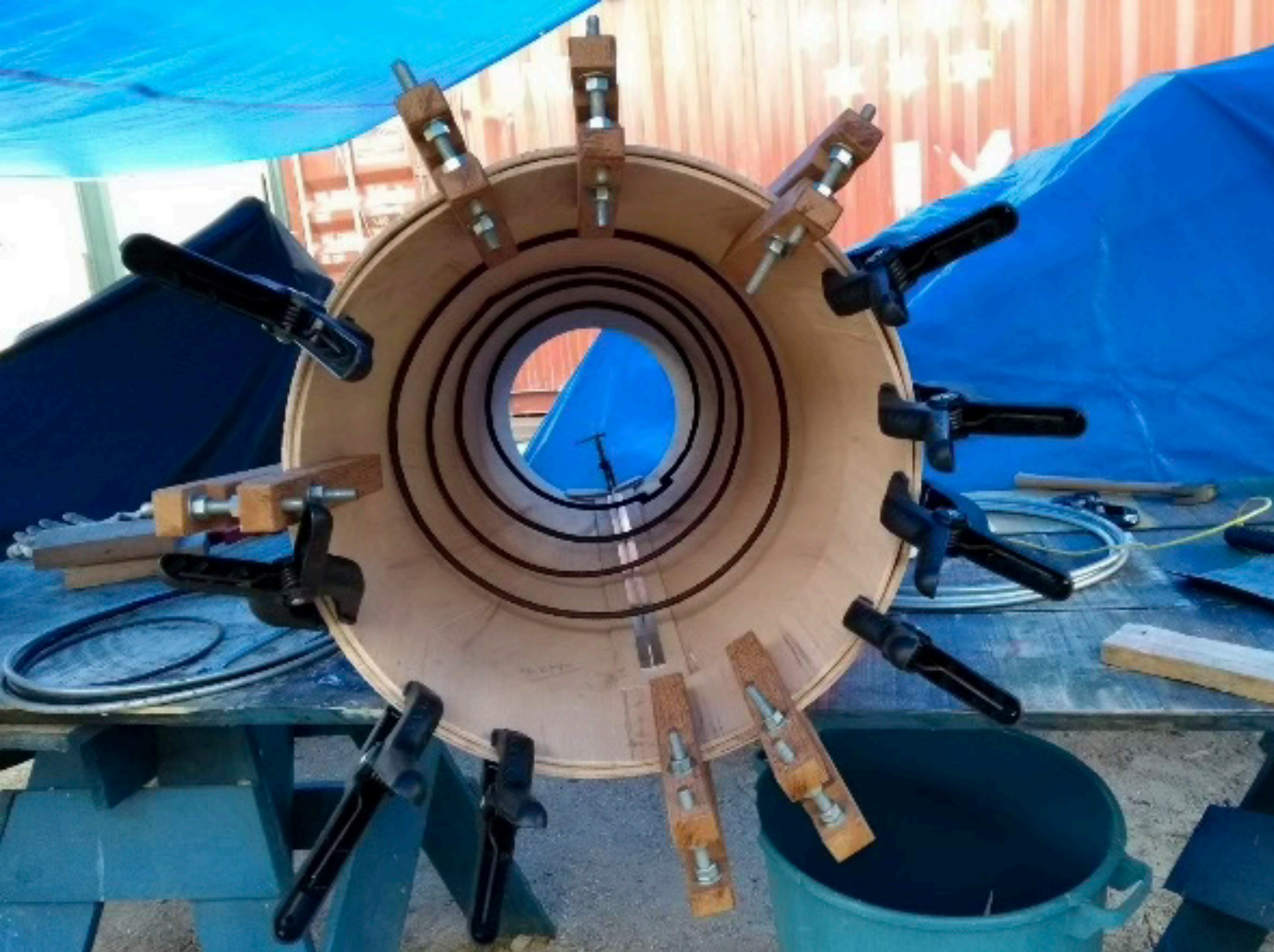
Figura 3 - registros do processo de confecção do corpo de um sopapo. Fonte: acervo dos autores, 2023.
