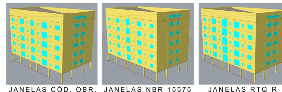
Figura 5: Janelas configuradas a partir das normativas para o edifício. Fonte: dos autores, 2020.
