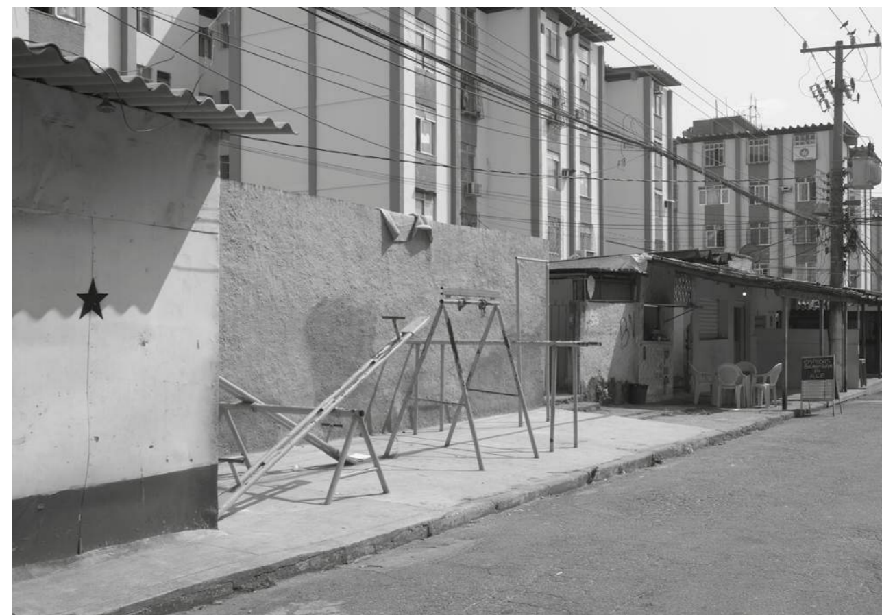
Figura 2 - Exemplo de ocupação de calçada por outras atividades que não a da função de circulação – neste caso a instalação de brinquedos que obriga os pedestres a compartilharem a caixa de rolamento com os veículos. Estes são assim obrigados a reduzir a velocidade em razão da presença dos pedestres – um objetivo hoje perseguido pelo mais avançado estado da arte em matéria de planejamento. Fonte: acervo do autor, 2024.
