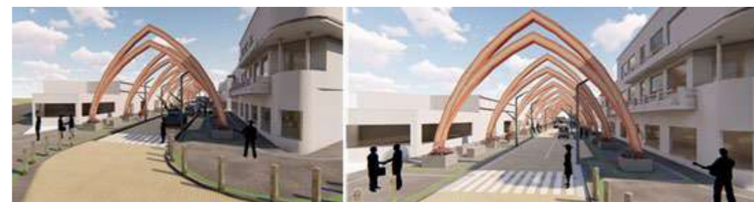
Figura 6: Proteção das esquinas e transição da pista de rolamento em nível. Fonte: Equipe de trabalho do projeto Viva Cidade Viva, 2018.
