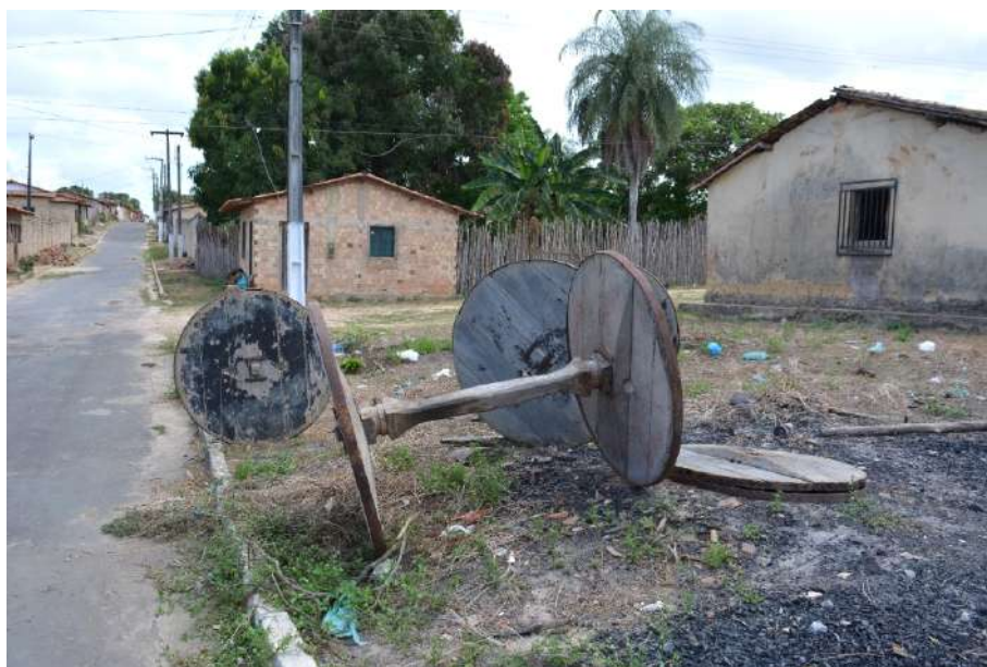
Figura 15: Eixos e rodas de carros de boi com peças de madeira envoltas em aros de ferro para ligação das peças. Fonte: BANDEIRA, 2018.
